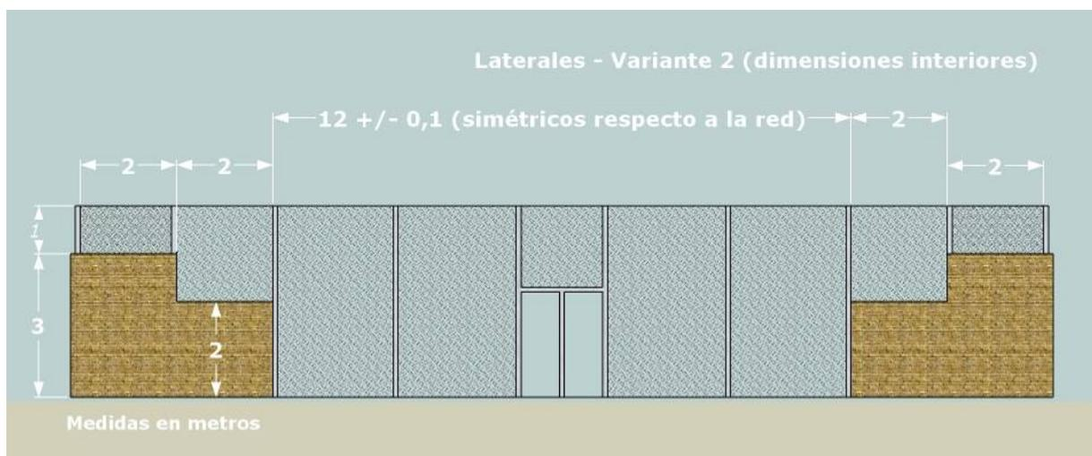
La malla metálica se coloca siempre alineada con la cara interior de las paredes.
